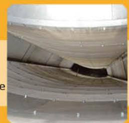
**4** Колонны для зерна шириной 324 мм окружающие нагревательную камеру, позволяют зерну получать максимальное количество теплоты от горелки, что повышает эффективность и обеспечивает существенное уменьшение уровня шума.
