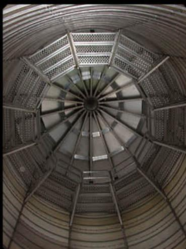
Башенная сушилка GSI разработана с учетом удобства эксплуатации. Смотровые мостики, лестницы и лестничные клетки обеспечивают легкий доступ ко всем областям сушилки. Доступ во внутренние секции сушилки обеспечивается четырьмя входами. Очистка, проверка и общее техническое обслуживание не представляют проблемы для башенной сушилки GSI. Усиленные материалы и жесткая конструкция обеспечивают надежную поддержку лестниц и платформ.
