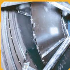
**12** Разделительная воронка отделяет секции нагрева и охлаждения друг от друга, предотвращая накопление твердых частиц.
