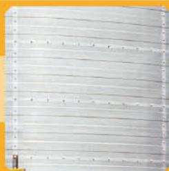
**3** Внешняя обшивка из нержавеющей стали значительно продлевает срок службы сушилки. Панели имеют разный диаметр перфорации, что уменьшает выбросы.
