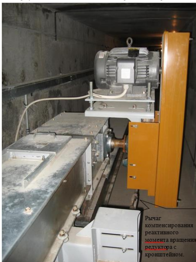
Рис.4. Приводная секция с двигателем
