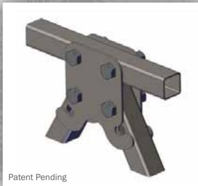
**СОЕДИНЕНИЕ БАЛКИ БАШНИ И ДИАГОНАЛЬНОГО ЭЛЕМЕНТА**
