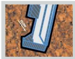
98,3 мм x 22,4 мм отверстия для гравитационного заполнения материалом
